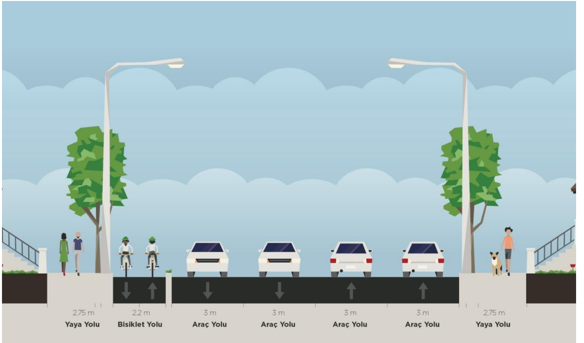
Şekil 8. 20 metre - Taşıt Yolu Profili
