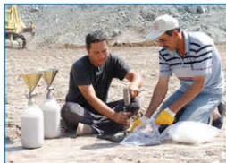
İnşaat sahasından alınan örnekler düzenli olarak kalite kontrol testlerine tutuldu.
