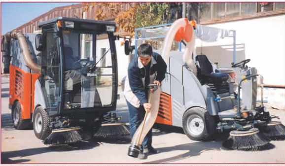
Her mevsim çalışabilen araçlar, caddeleri süpürmesinin yanı sıra ağaçlardan dökülen kuru yaprak-larıvakumlu hortumu aracılığı ile toplama gibi pek çok işte de sahip.
