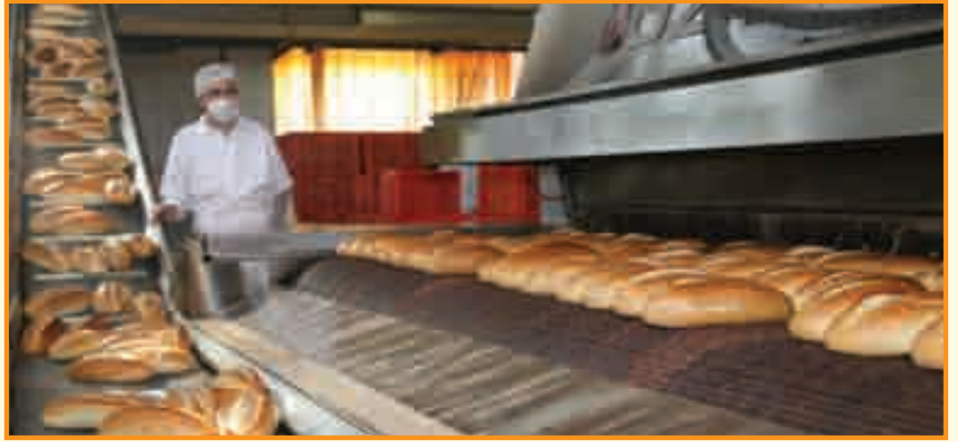
Son teknoloji ürünü tünel fırınlarda pişirilen halk ekmeği (üstte), otomatik paketlenme makinelerinde el değmeden paketleniyor. (altta)
