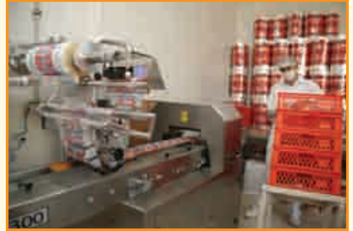
Son teknoloji ürünü tünel fırınlarda pişirilen halk ekmeği (üstte), otomatik paketlenme makinelerinde el değmeden paketleniyor. (altta)
